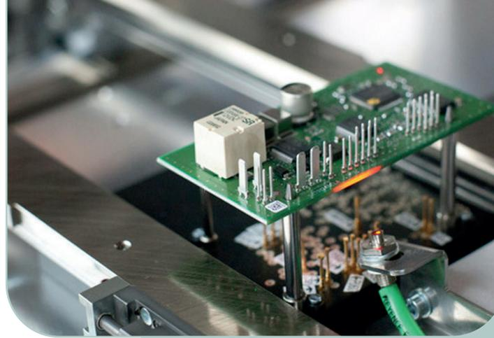
Die **baumann telbox** ist die standardisierte und flexible Plattform für Prüftechnikapplikationen. Im Einsatz zur Prüfung von Leiterplatten und Steuergeräten, wird zuverlässig die Forderung nach Qualitätssicherung und Null-Fehlerstrategie in der Produktion erfüllt.
